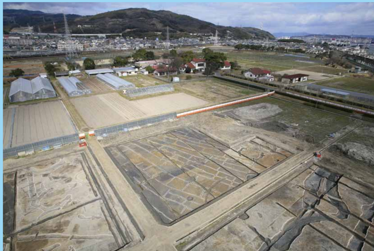
井堰 2（6区 北東から）※ 杭を打ち込み、横木を渡して、つくられています。 弥生時代中期末から後期初頭の堰です。
