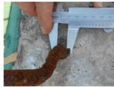
【37】 上抜け 減厚後の径 11mm
