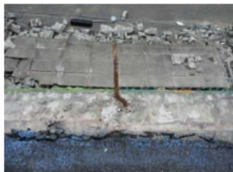
【39】上抜け 定着筋長さ:285mm
