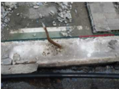
【3】上抜け 接合筋長さ:240mm
