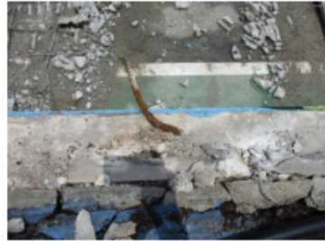
【2】上抜け 接合筋長さ:245mm
