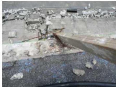
【37】上抜け 定着筋長さ:150mm
