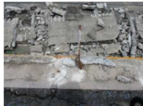
【28】 上抜け 接合筋長さ:270mm
