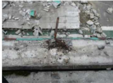
【45】 上抜け 接合筋長さ:240mm
