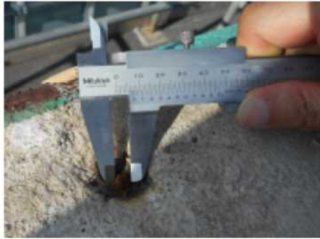
【18】 破断 減厚後の径 8mm
