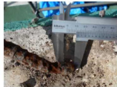
【45】 上抜け 減厚後の径 12mm
