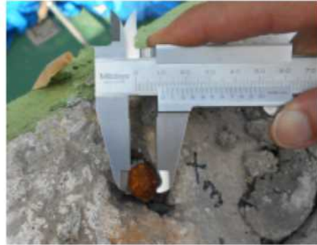
【7】 破断 減厚後の径 11mm
