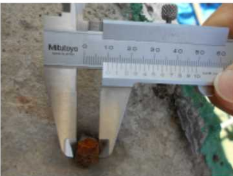
【46】 破断 減厚後の径 10mm
