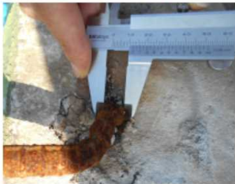
【35】 上抜け 減厚後の径 12mm
