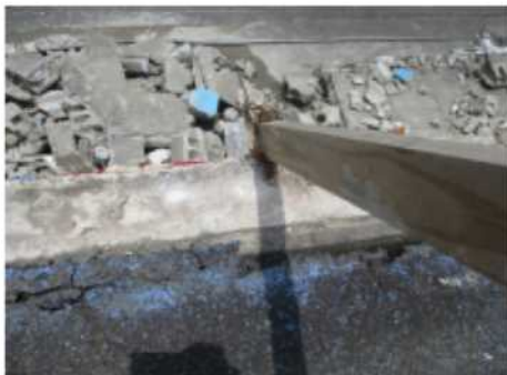
【21】 上抜け 接合筋長さ:235mm
