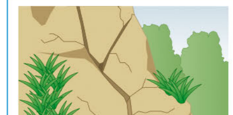
斜面にひび割れができる。
