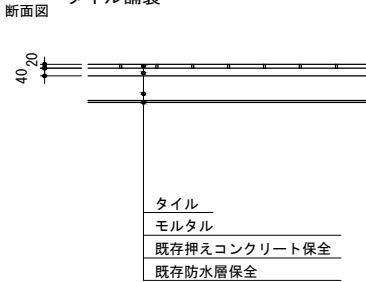
舗装A3・A3B 舗装A、A2に連続する北館地下躯体上部 タイル舗装 S=1:40
